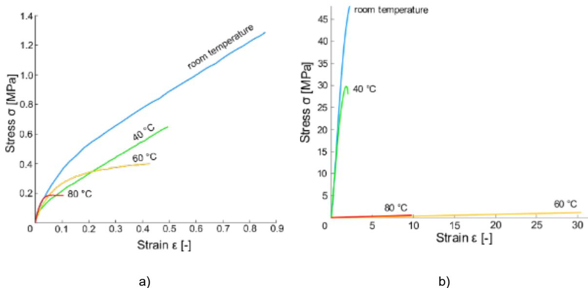
Fig. 4: Stress- strain relation. a) Loctite® EA 9455 (Boutar , Eliášová, Tichá, & Zikmundová, 2023). b) EPOX® G300.
